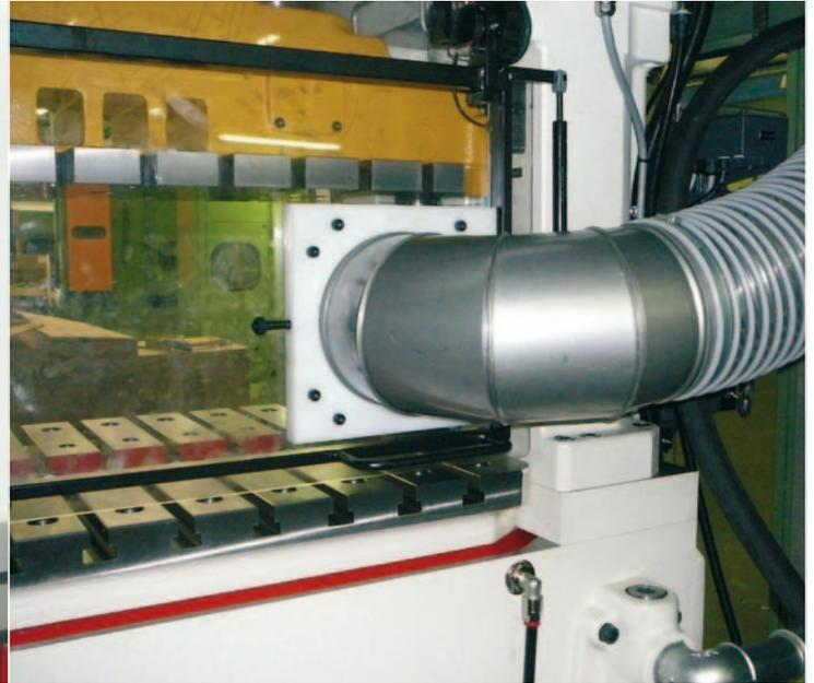
**Equipos de engrase ECO-PUL y PUL con boquillas tipo W, instalados en prensas de alta viscosidad**
