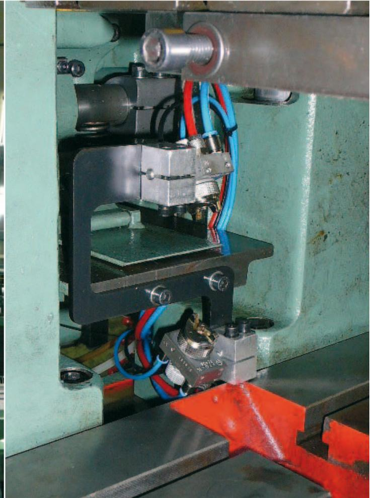
**Equipo de engrase ECO-PUL y PUL con boquillas tipo W, instalado en prensa Bruderer**
