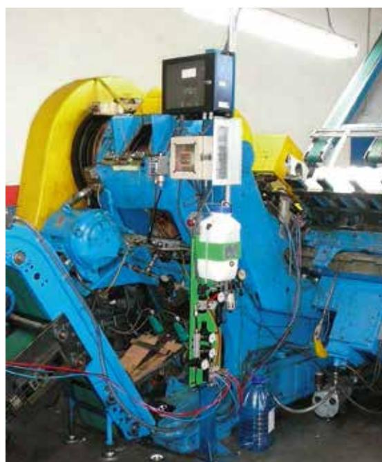
Instalación para la embutición bote cilíndrico y base aerosol
