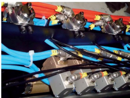
DETALLE MONTAJE BOQUILLAS. Boquillas totalmente fabricadas en acero inoxidable.
